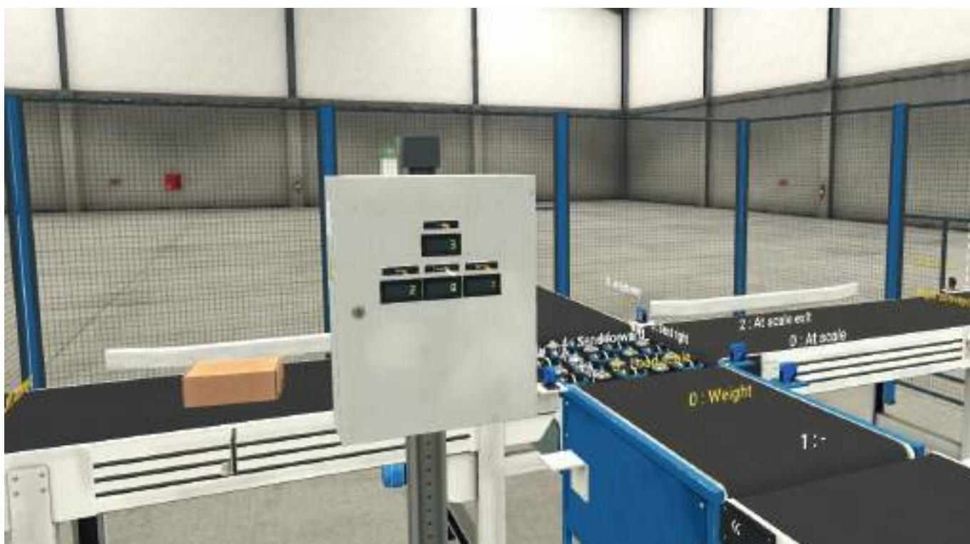
Рис. 3. Панель управления: счётчики весовой секции
