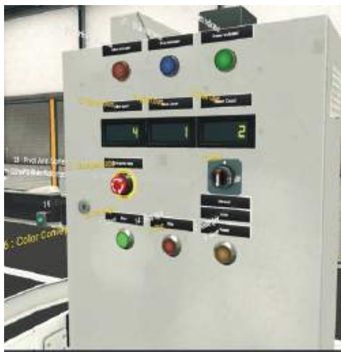
Рис. 4. Панель управления: индикаторы и счётчики цветовой секции
