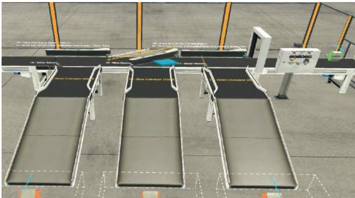
Рис. 2. Цветовая секция: Pivot Arm Sorter и датчики
