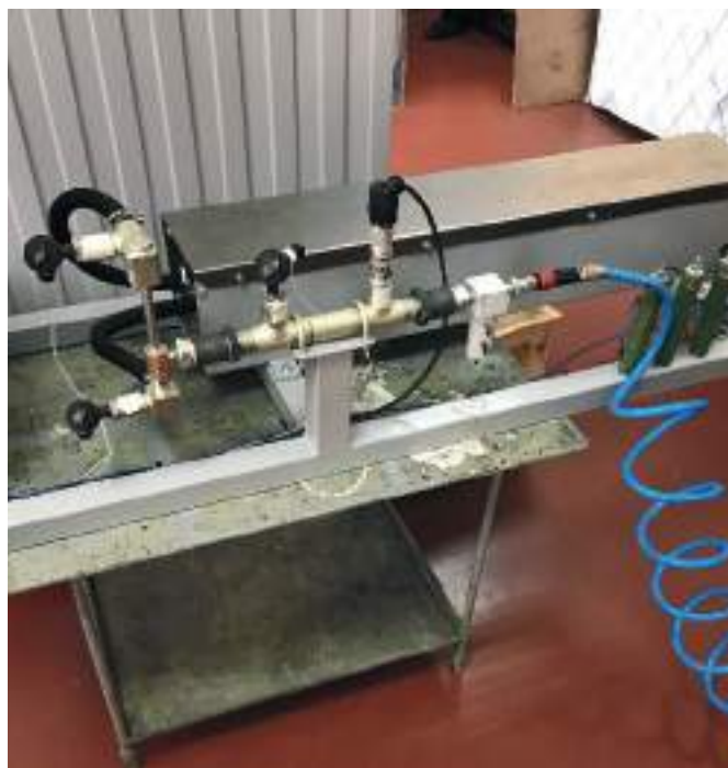
Рис. 1. Экспериментальная термоэлектрическая генераторная установка
