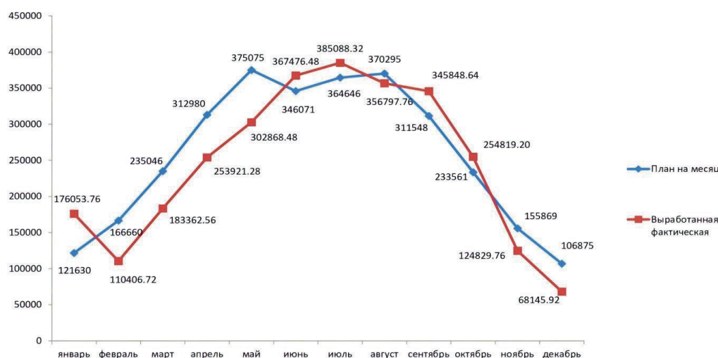
Рис. 2. Графики выработанной и плановой электрической энергии в 2023 г., кВт·ч
