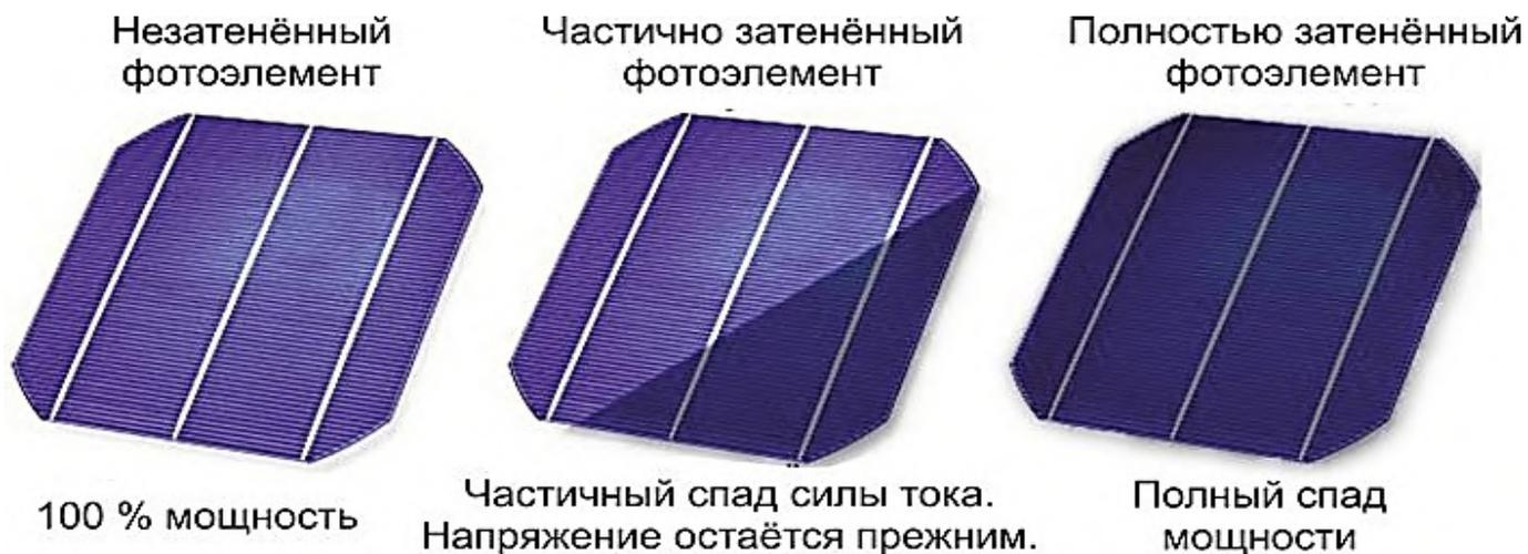
Рис. 4. Влияние затенения на работу фотоэлектрического элемента
