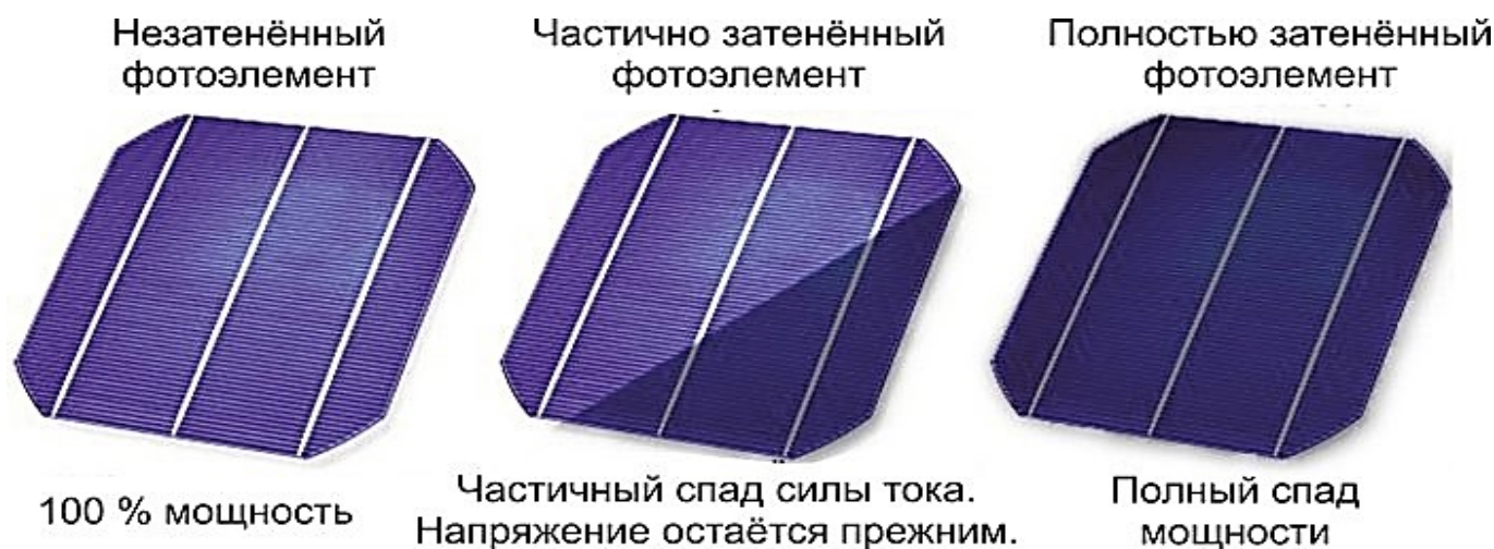
Рис. 4. Влияние затенения на работу фотоэлектрического элемента
